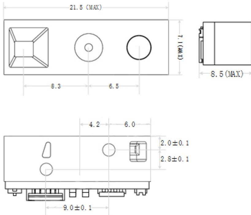
MOV2底部有2个 M1.4螺钉孔可供选择安装使用,当螺钉安装孔位是朝下时,下图表示了正确放置或安装时的外观(注:螺钉安装深度不超过2mm)。
